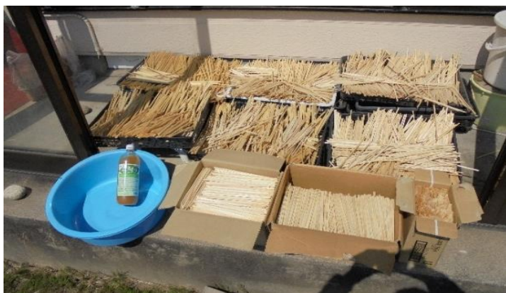
<割箸を回収、EMぼかし菌で洗浄し、紙の原料としてリサイクル>
